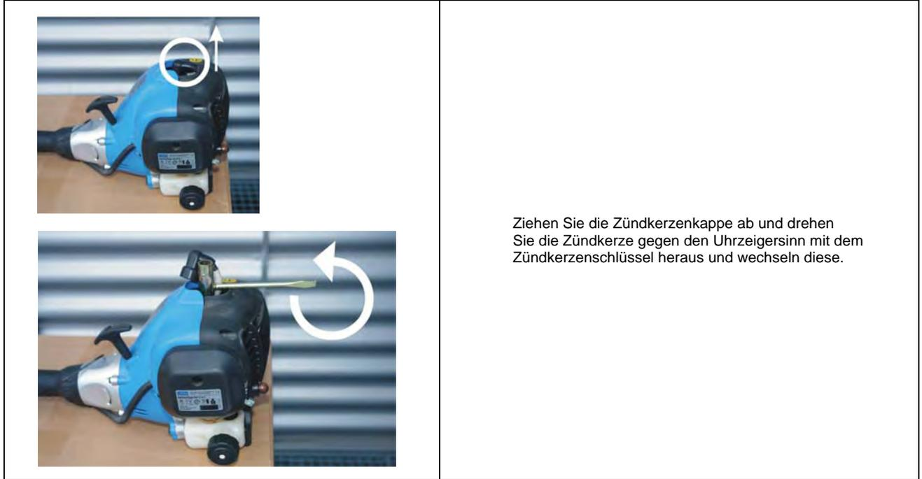
Ziehen Sie die Zündkerzenkappe ab und drehen Sie die Zündkerze gegen den Uhrzeigersinn mit dem Zündkerzenschlüssel heraus und wechseln diese.
