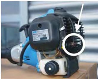
Betätigen Sie die Primerpumpe 3-5 mal.
