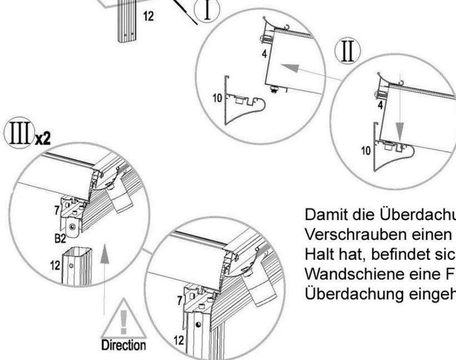
Damit die Überdachung vor dem Verschrauben einen gewissen Halt hat, befindet sich außen an der Wandschiene eine Führung in der die Überdachung eingehängt werden kann.
