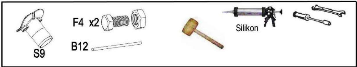
Dichten Sie den Übergang zwischen den Stegplatten und den Aluschienen ordentlich mit Silikon ab, damit sich in den Zwischenräumen kein Regenwasser oder Schmutz sammeln kann.
