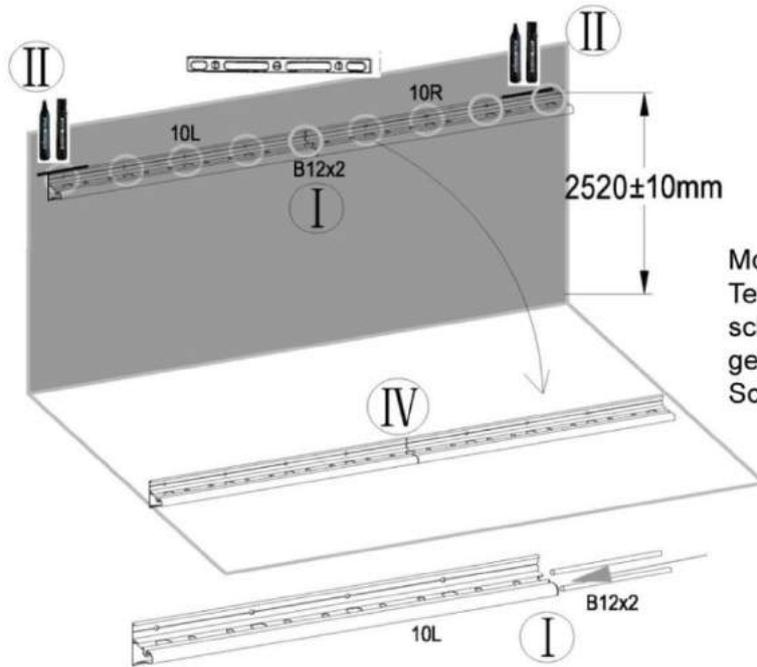
Montieren Sie vor Aufbau der Terrassenüberdachung die Wand-
