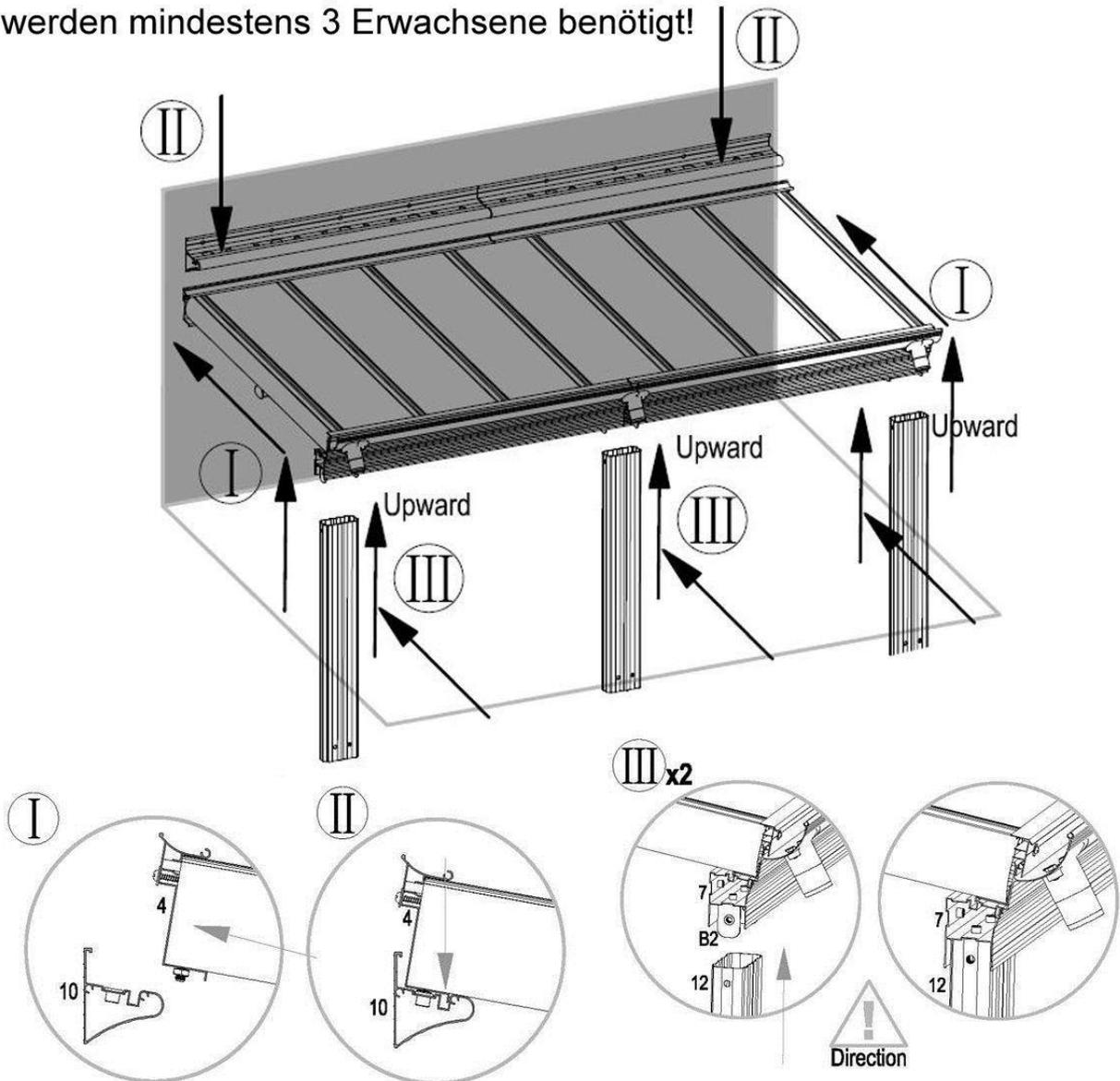
Damit die Überdachung vor dem Verschrauben einen gewissen Halt hat, befindet sich außen an der Wandschiene eine Führung in der die Überdachung eingehängt werden kann.
