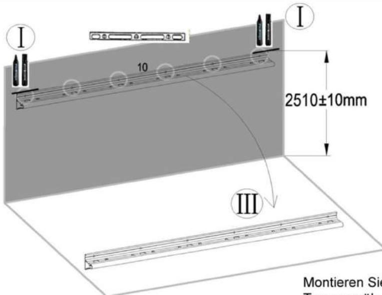
Montieren Sie vor Aufbau der Terrassenüberdachung die Wand-schiene. Zum Schluss wird die gesamte Überdachung auf diese Schiene gelegt und verschraubt.
