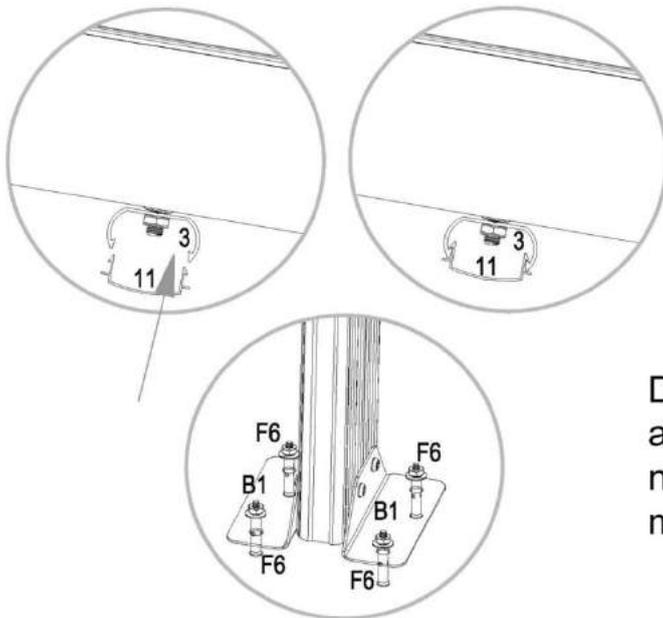
Decken Sie alle F6-Teile ab. Damit die Teile sich nicht lösen, schlagen Sie diese mit einem Holzhammer fest.
