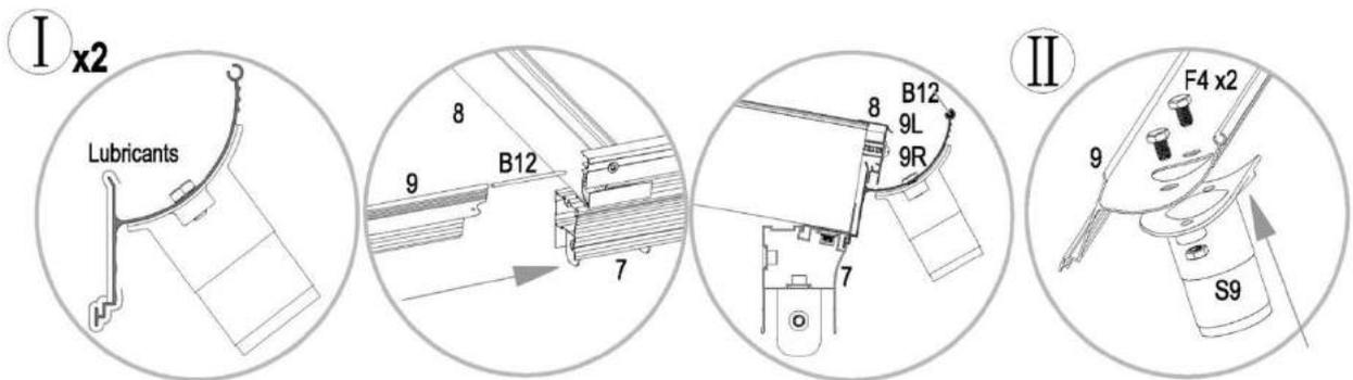
9L und 9R lassen sich leichter installieren, wenn Sie Schmierstoff verwenden.
