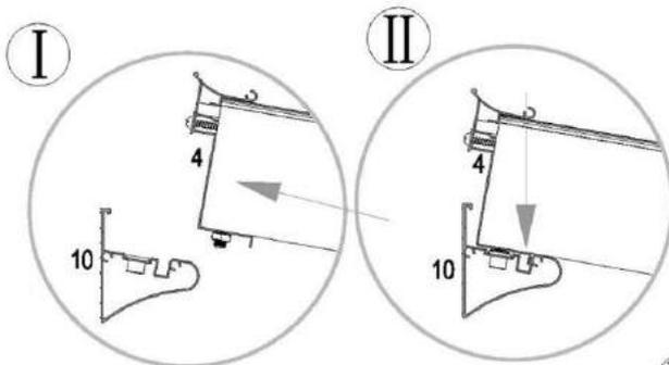
Damit die Überdachung vor dem Verschrauben einen gewissen Halt hat, befindet sich außen an der Wandschiene eine Führung in der die Überdachung eingehängt werden kann.
