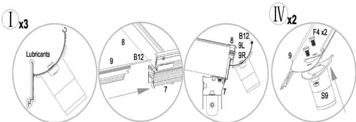
9, 9L und 9R lassen sich leichter installieren, wenn Sie Schmierstoff verwenden!
