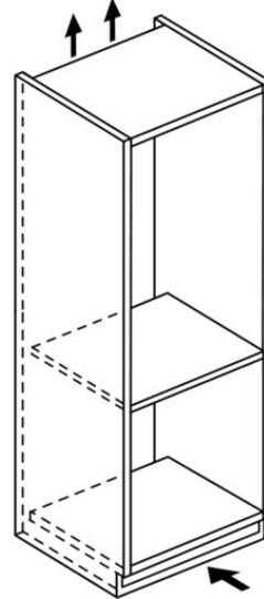
Belüftung im Sockel min. 200 cm<sup>2</sup>
