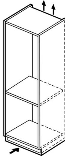
Belüftung im Sockel min. 200 cm<sup>2</sup>
