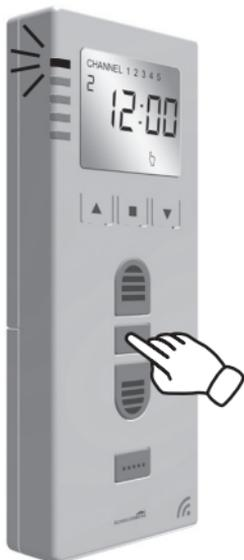
Schritt 18 und 19 innerhalb 4 Sekunden ausführen. Beide Tasten kurz gleichzeitig drücken.
