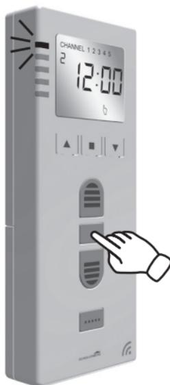
Schritt 15 und 16 innerhalb 4 Sekunden ausführen. Beide Tasten kurz gleichzeitig drücken.
